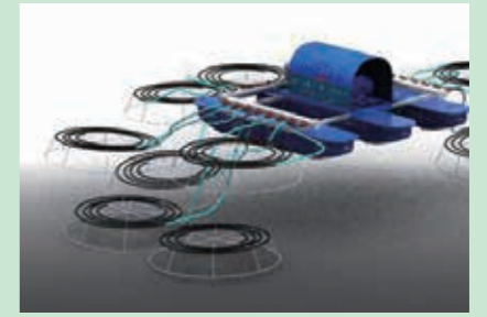
图7：浮床式微孔增氧示意图
